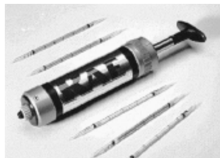
Figura 5-13: DETECTOR COLRIMÉTRICO RAE CON TUBOS COLRIMÉTRICOS
